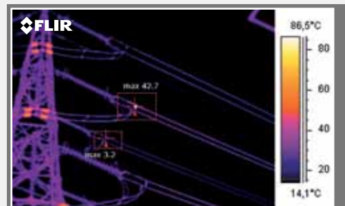
Изображение с разрешением 320 x 240 пикселей и термочувствительностью 50 мК. Обратите внимание на то, как при увеличении разрешения повышается точность измерения температуры на горячем участке.
